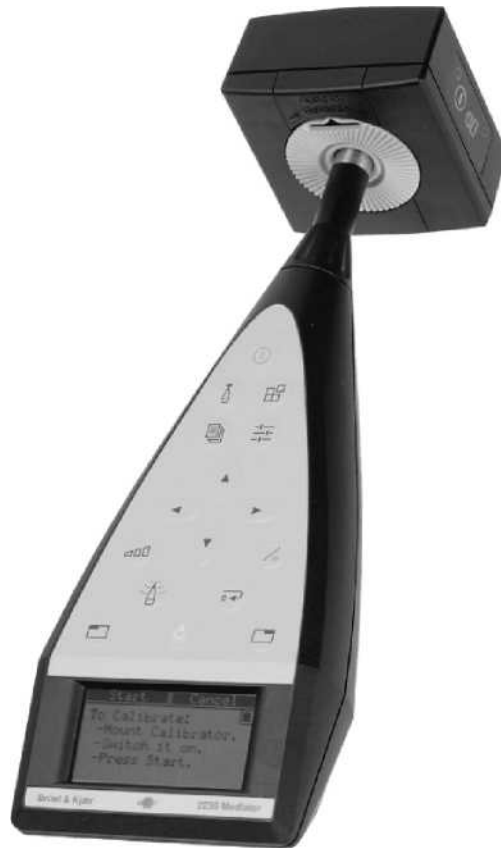
Фиг. 2.1 Поставяне на калибратора на шумомер 2238 Mediator™
